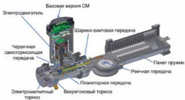
Четверть поворотный привод 90° (СМ+МФ) в разрезе.
